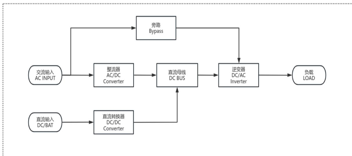
H 系列在线双变换结构，主要由交流滤波器，交流升压，直流滤波器，直流反接保护装置，逆变装置，旁路，DSP 数字控制部分，显示和监控部分构成。
