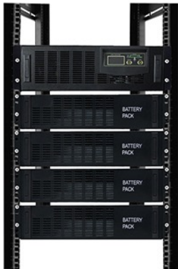
6KVA+四个48V50AH锂电池包 4000W备用2小时 解决方案
