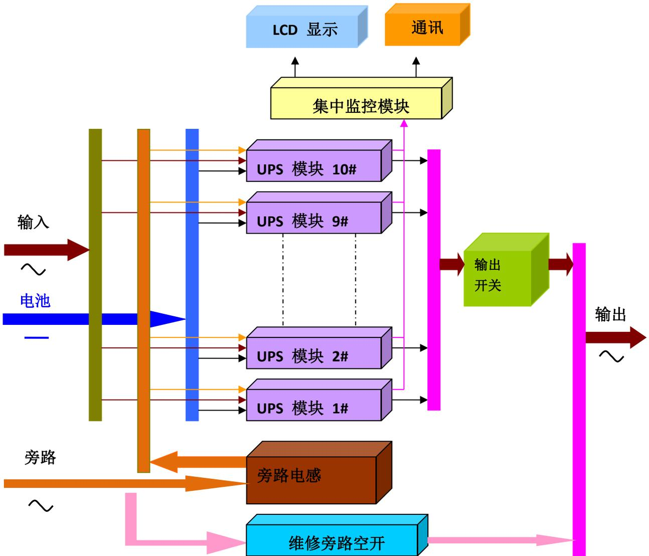
图 2-1 机柜原理框图
