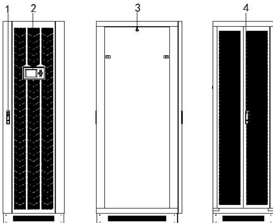
图1-5 机柜前视图、柜侧视图、机柜后视图
