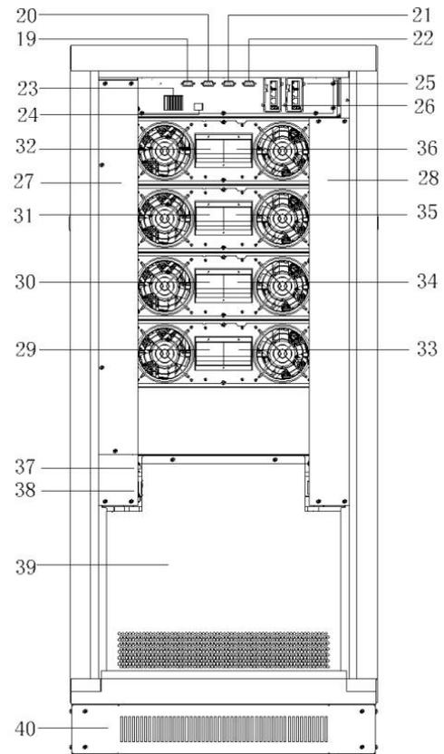
图1-7 90kVA机柜后视图（除门）
