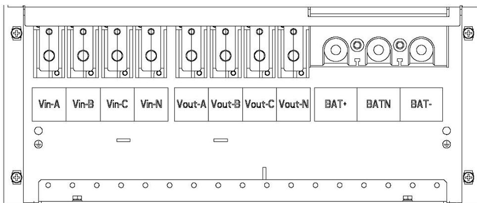
图1-12 150kVA机柜接线排图（除接线排档板）
