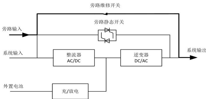
图 2-8 旁路维修模式原理图
