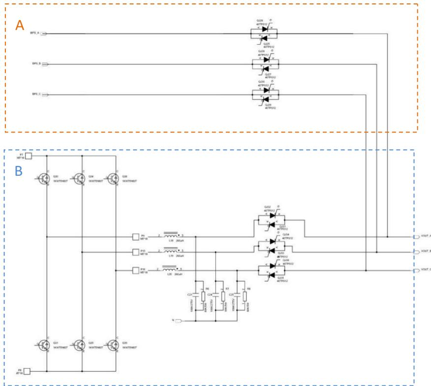
图 9.功率模块旁路和逆变器原理
