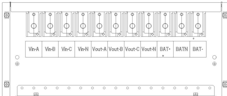
图1-8 90kVA机柜接线排图（除接线排挡板）
