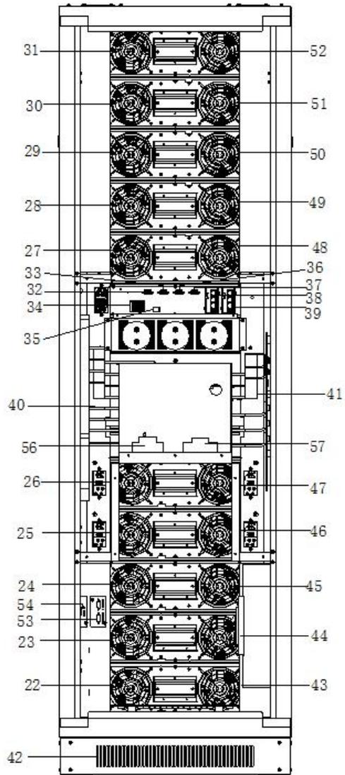
图1-15 300kVA机柜后视图（除门/除接线排挡板）
