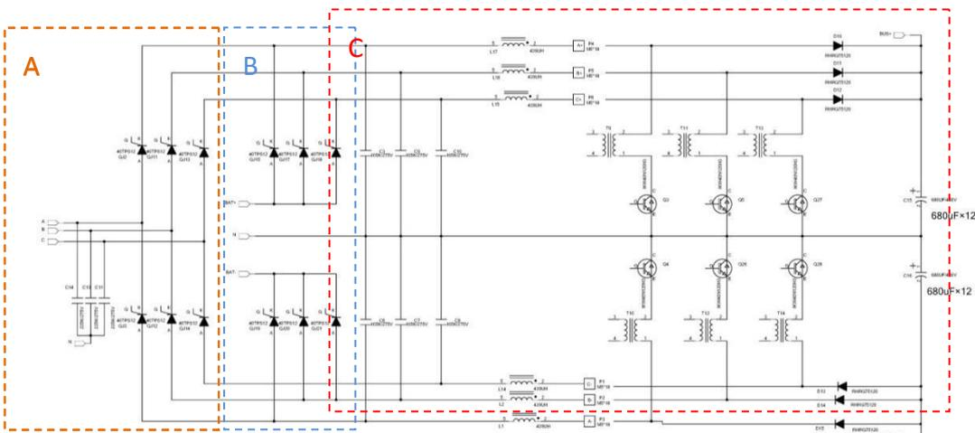
图 2-3 功率模块 AC/DC & DC/DC 原理
