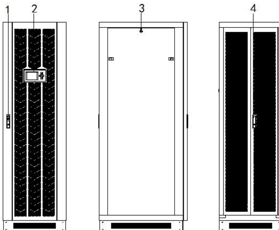
图1-9 机柜前视图、机柜侧视图、机柜后视图
