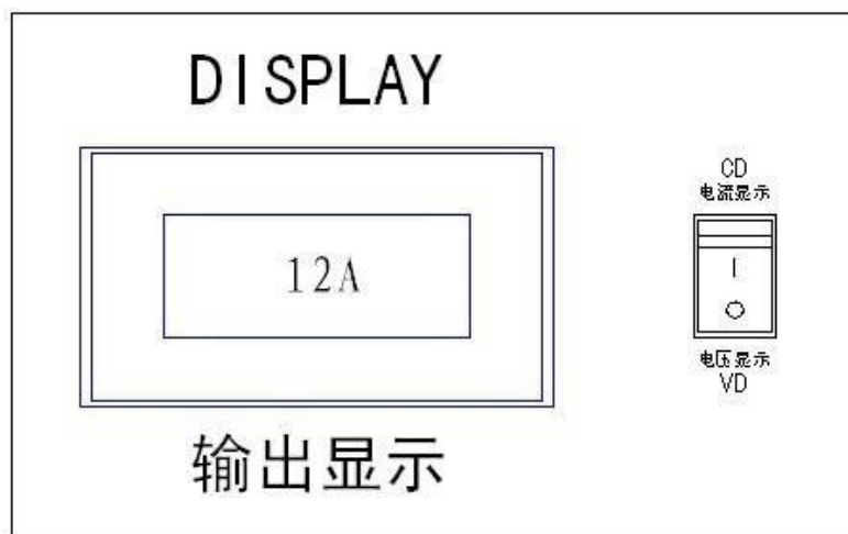
图 2-3 输出电流显示示意图
