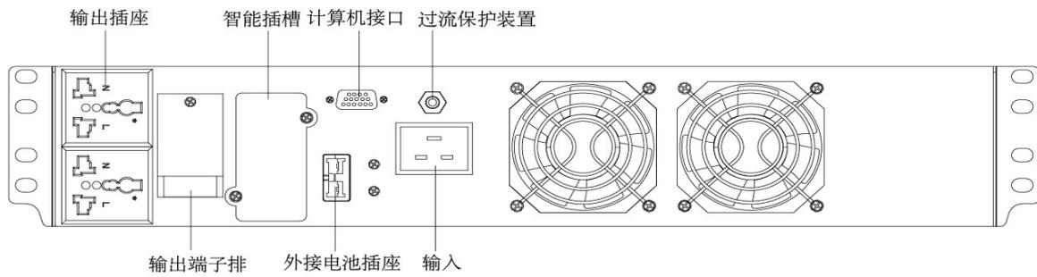
ET3KRS 机架式 UPS 后盖板示意图
