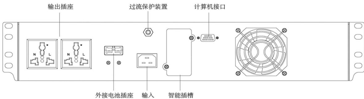
ET1KSR 机架式 UPS 后盖板示意图
