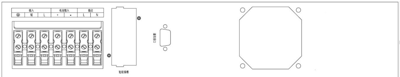
ET1KRS 机架式 UPS 后盖板示意图
