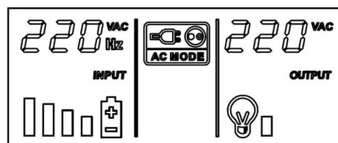
市电模式开机图（市电和电池都接入）
