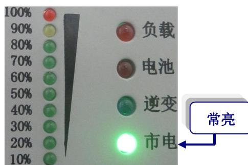
市电输出正常带负载，市电指示灯亮，负载容量百分比指示灯亮
